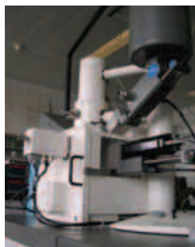
Microscope électronique à balayage avec capteurs EDX, WDS et EBSD
