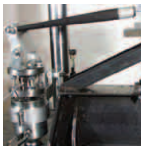
Essai de fatigue sur une fourche de vélo en fibre de carbone
