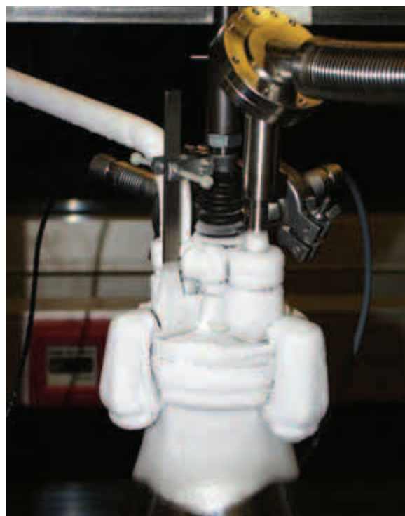
Givre sur un cryostat au cours d'un essai de fatigue à 4k
